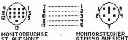
Da in CTM kein Lautsprecher ein-gebaut ist benötigt man einen ex-ternen Verstärker. Der Anschluß erfolgt beim ST über Pin 1 und 13, beim STE über die Cynchbuchsen.
